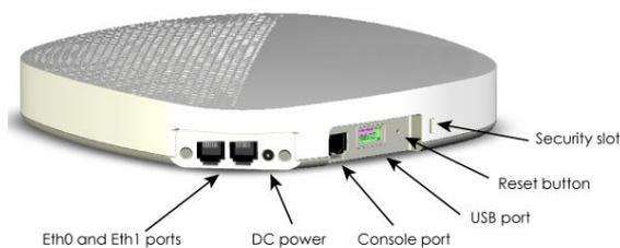
Es werden zwei RJ45-Schnittstellen unterstützt: 1 x 2,5 und 1x 10/100/1000 Mbit/s; Beide Schnittstellen unterstützen Auto-Negotiation.
