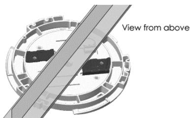
Der AP410C wird mit einer Montagehalterung für 15/16 Zoll bündig montierte Deckenplatten (AH-ACC-BKT-AX-TB) geliefert.
