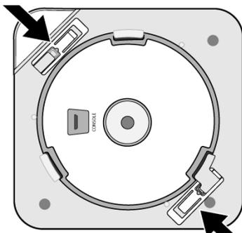
Der AP305C/CX besitzt zwei Halteklammern zur schraubenlosen Befestigung an den Schienen standardisierter, abgehängter 15/16-Zoll-Elementdecken
