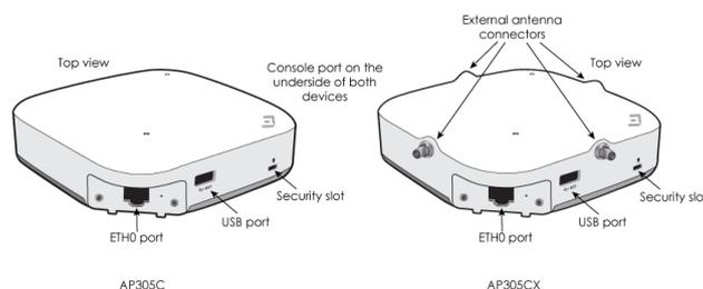
Der AP305CX verfügt über vier RP-SMA-Stecker zum Anschließen von Dualband-Dipolantennen. Beachten Sie dabei: Mit der Bestellnummer AH-ACC-ANT-AX-KT werden 8 Antennen geliefert, ausreichend für jeweils zwei APs. Der Gewinn dieser 2,4 / 5-GHz-Antennen mit liegt bei 3 bzw. 5-dBi.
